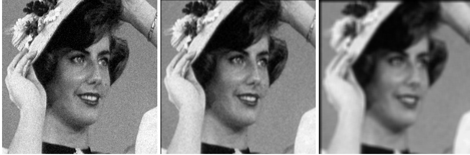
FIG. 10.1 – Filtres de moyenne - A gauche, image bruitée par un bruit gaussien de variance 120, au centre, filtrage passe-bas sur une fenêtre 3 \times 3 , à droite sur une fenêtre 7 \times 7 .
